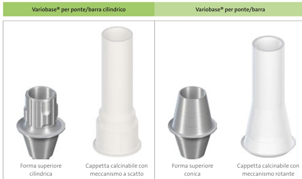
Entrambe le componenti protesiche Variobase® per ponte/barra sono fornite con connessione conica non a incastro sull'impianto, che consente una compensazione di max.15 gradi di divergenza per asse implantare.
